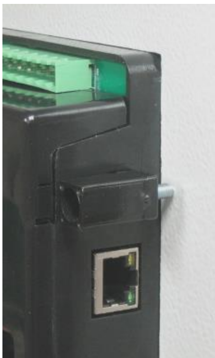
Установка кронштейна винтового типа
