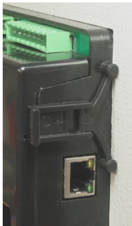
Установка самоудерживающегося кронштейна
