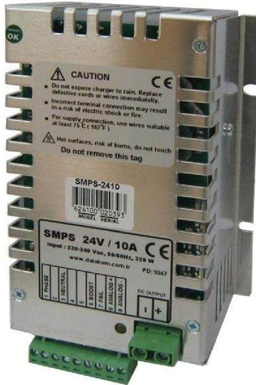
В качестве стандартной функции устройства оснащено функцией «повышенного заряда». Когда этот вход подключен к отрицательной клемме аккумулятора, выходное напряжение зарядного устройства будет установлено на значение повышенное напряжения заряда. Этую функцию можно использовать временно, чтобы увеличить время автономной работы.
