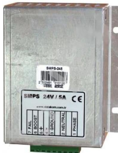
Зарядное устройство имеет полупроводниковый выход ошибки схемы преобразования (FAIL), имеющий отрицательный потенциал батареи в случае неработоспособности системы. Данный выход предназначен для подключения к модулю управления электрогенераторной установкой в целях сигнализации ошибки и ее отображения ее типа на экране.
